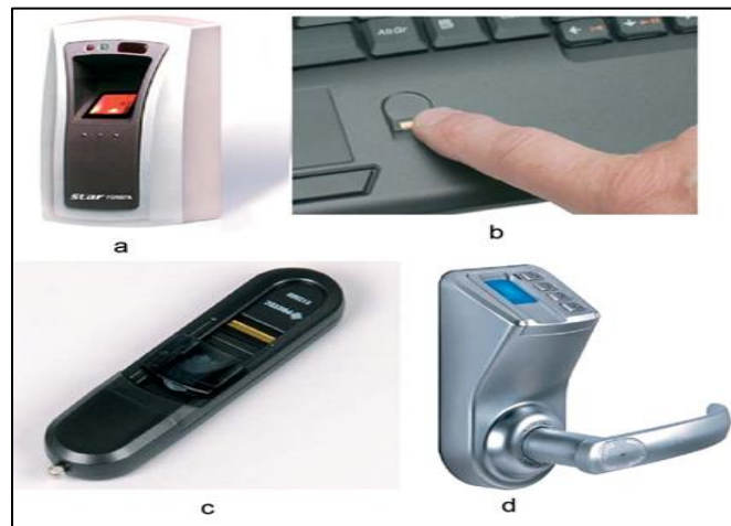
Figura 3. Los lectores de huellas dactilares pueden proteger el acceso a un área restringida, a un Pc portátil, una memoria USB o el uso de una puerta. Fuentes: Elaboración propia a partir de imágenes de Securityinfowatch (2012) , Trustedreviews (2012) , Zive (2012) , Adelshop (2012)
