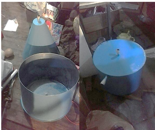
Figura 6.6. Revestimiento en fibra de vidrio de estanques cilíndricos y estanque cónico.
