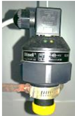
Figura 6.8. Sensor de nivel ultrasónico Dinel ULM – 53N-02-I. Fuente: Elaboración propia.
