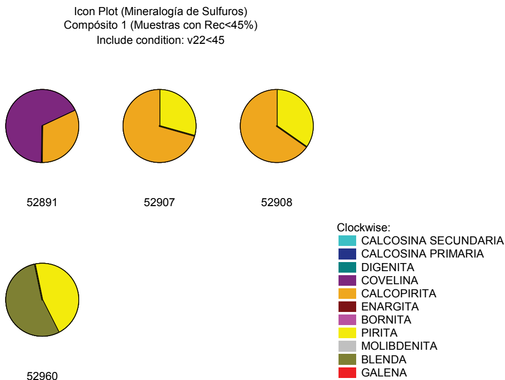
Figura . Diagramas Pie con la mineralogía de sulfuros de un subgrupo de muestras del compósito 1 que exhibió recuperaciones menores a 45%. Estas muestras presentan menor intensidad de calcosina secundaria y mayor intensidad de covelina y calcopirita.
