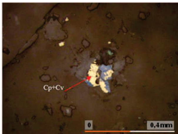
Fotomicrografía . Muestra 52967. Calcopirita (Cpy) con reemplazo parcial de covelina (Cv).
