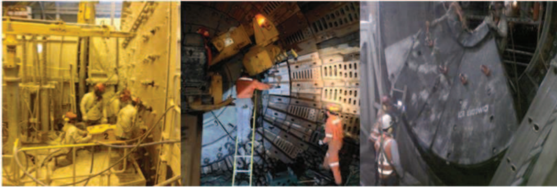
Figura n° 9: Actividades de cambio revestimientos en molinos SAG y Bolas.
