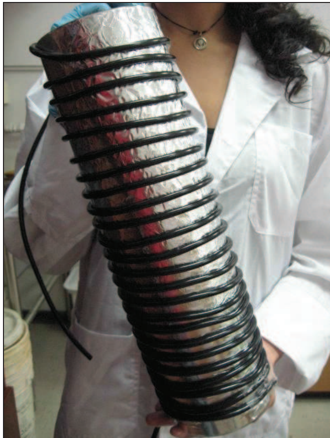
Figura 25: Sistema de calentamiento de las columnas.
