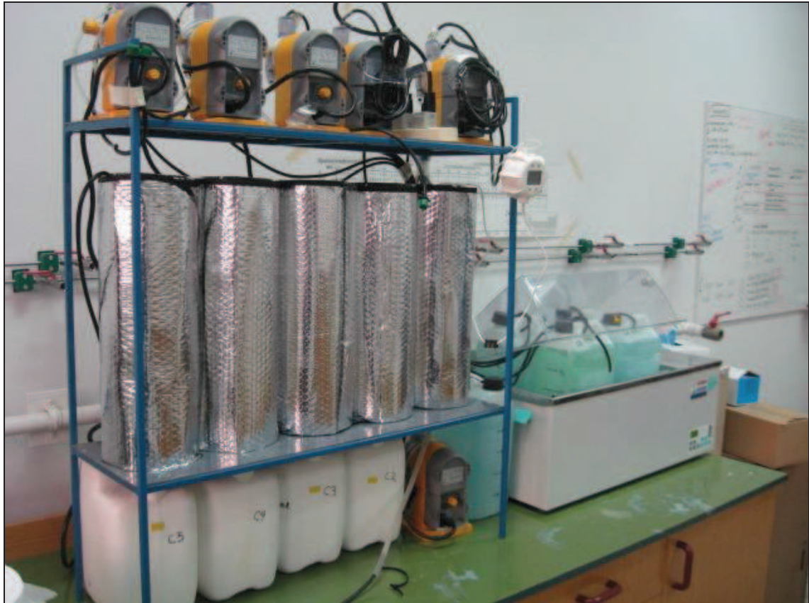
Figura 27: Sistema de riego y calentamiento de columnas de lixiviación.
