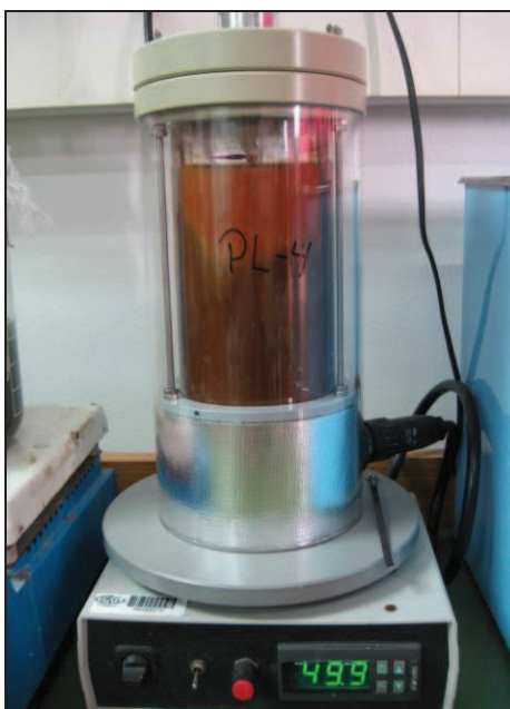
Figura 36: Imagen de la prueba realizada a 2 < \text{pH} < 4,5 , con concentrado de calcopirita ( -38+25 \mu\text{m} ) en reactor instrumentado a 50^\circ\text{C} , 50 \text{ g/L} de \text{Cl}^- y 0,5 \text{ g/L} de \text{Cu}^{2+} , donde se puede apreciar la tonalidad rojiza de los residuos.
