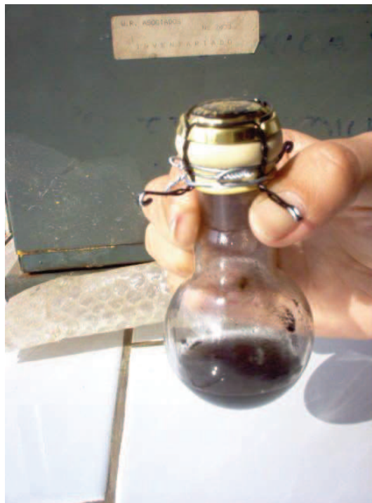
Figura 12. Reactor fondo redondo para síntesis solvotermal.
