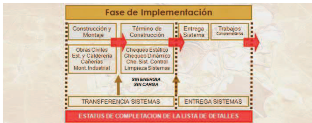
Figura 2.16. – Punch list al término de construcción del proyecto
