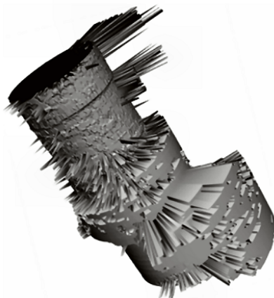
Figura 3.1: Imagen 3-D obtenida a partir de los datos del registro de tiempo de tránsito de la onda desde el emisor hasta la pared del pozo[13]. Los breakouts existentes se identifican en la imagen como las zonas externas a las paredes del pozo.
