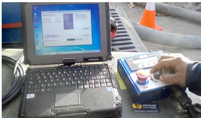
Figura 2.5: Computador de terreno utilizado para el registro de información del sondaje[28].
