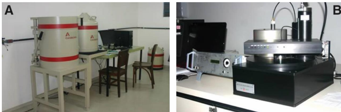
Fig. 2.2. A) detector de germanio de alta resolución para espectrometría gamma. B) lector de luminiscencia Risø TL-DA 20.
