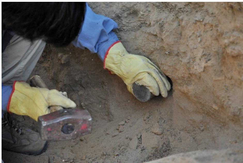
Fig. 2.13. Toma de muestras en terreno. El tubo es introducido paralelamente a la estratificación mediante percusión con una maza y evitando que la luz entre por el lado opuesto del tubo.
