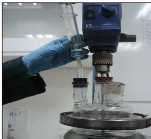
Figura 28: Jeringa adherida a la pipeta para toma de muestra desde reactor
