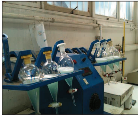
Figura 31: Agitación de refino con solvente
