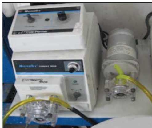
Figura 29: Bombas de la celda de extracción
