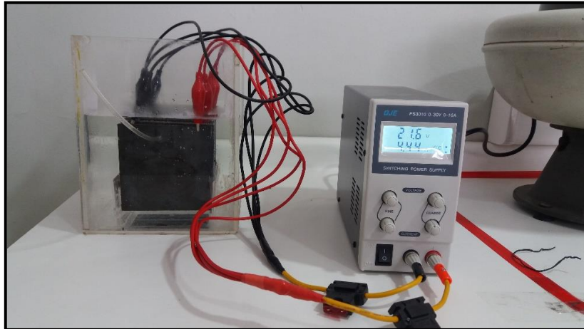
Figura 7. Ensayos celda de electrocoagulación con agua
