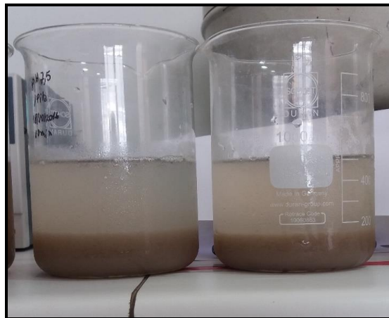
Figura 21. Sólidos obtenidos de la prueba de jarra.
