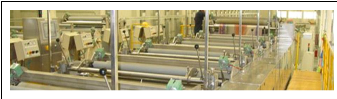
Figura 21 Tratamiento superficial lámina de cobre
