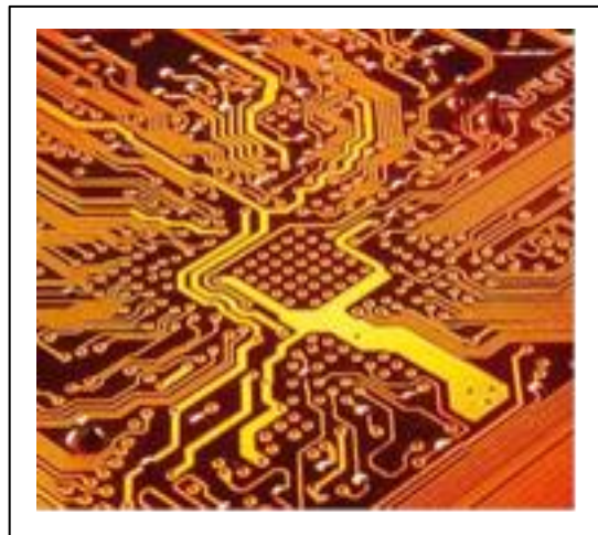
Figura 29 Lámina de cobre utilizado por la Industria electrónica de las Tarjetas electrónicas
