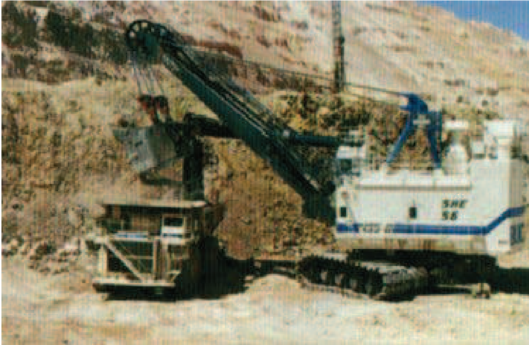
Figura 4.1 Vista de la operación de una pala Electromecánica
