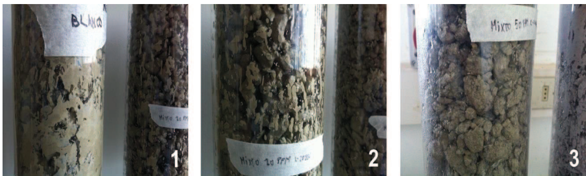
Figura 56: Aglomeración de mineral sin surfactante (1), 20 ppm (2) y 50 ppm (3) de surfactante L-20886.
