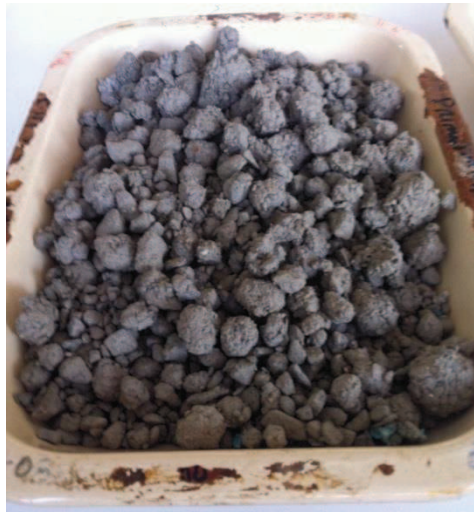
Figura 57: Aglomeración de mineral oxidado de cobre con una dosificación de 20 ppm de L-15767
