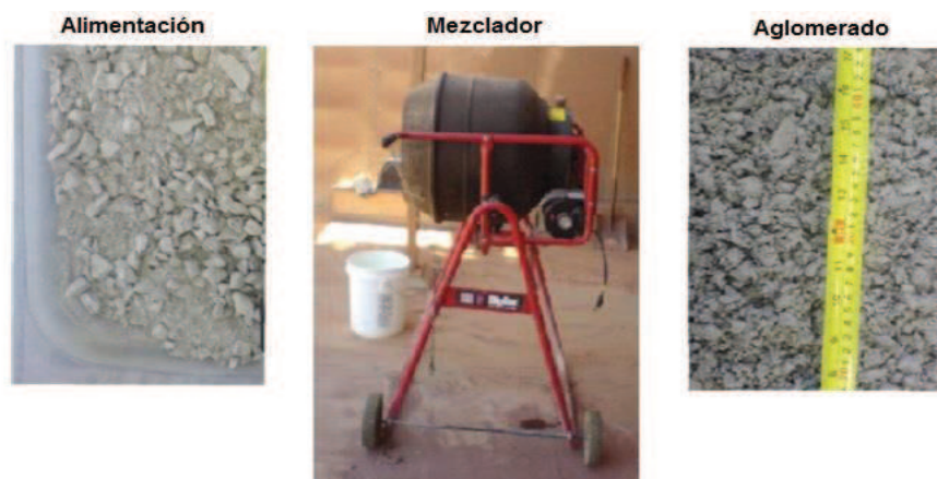
Figura 12: Alimentación, mezclador de cemento y material aglomerado
