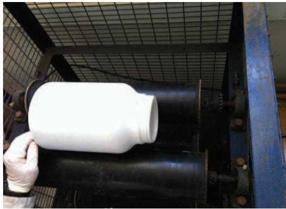
Figura 21: Aglomeración de muestras minerales
