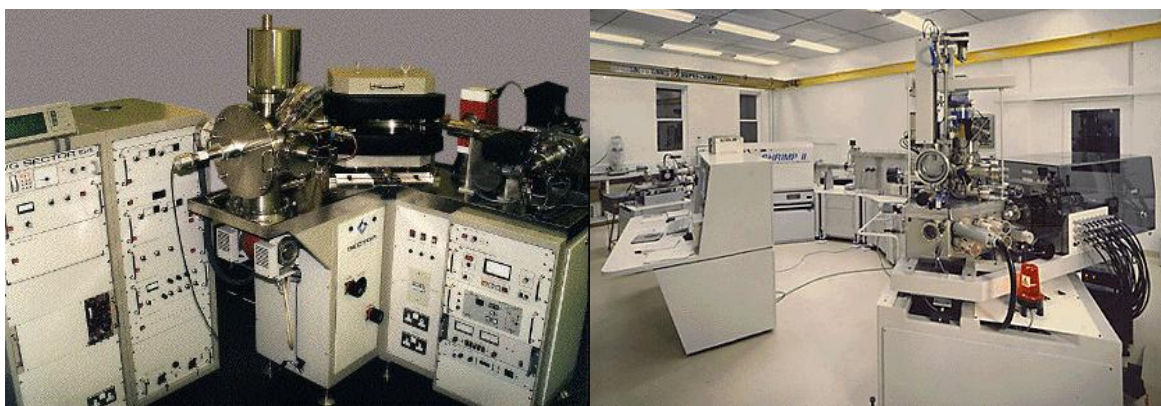
Figura 2. A la izquierda se observa un instrumento TIMS (VG-54) y a la derecha en perspectiva un SHRIMP II.
