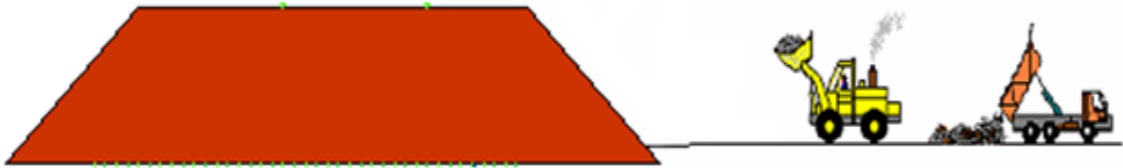
Figura 29: Descarga de pilas de lixiviación. (Fuente: SEIA, 2016)
