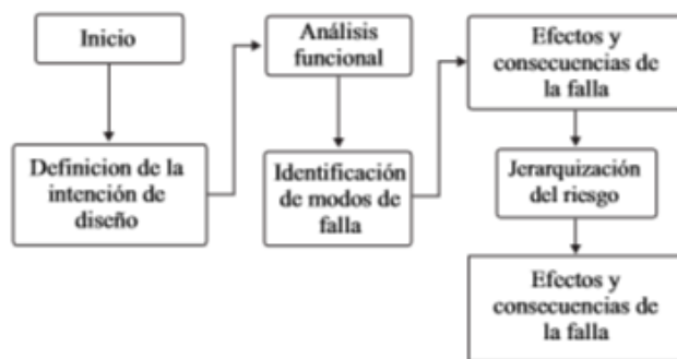
Figura 44: Esquema de la metodología de análisis de modos de falla y sus efectos. (Fuente: Aguilar Otero et.al. , 2010)
