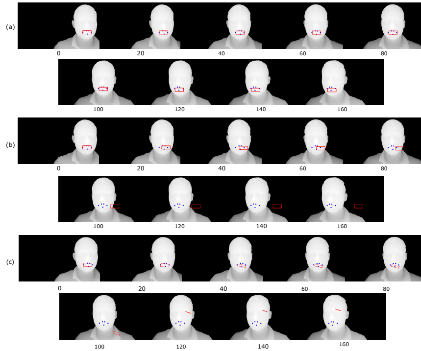
FIGURA 5.2: Secuencia de imágenes de profundidad generadas y proceso de seguimiento aplicando el algoritmo (a) aditivo, (b) de composición inversa, (c) aprendizaje.
