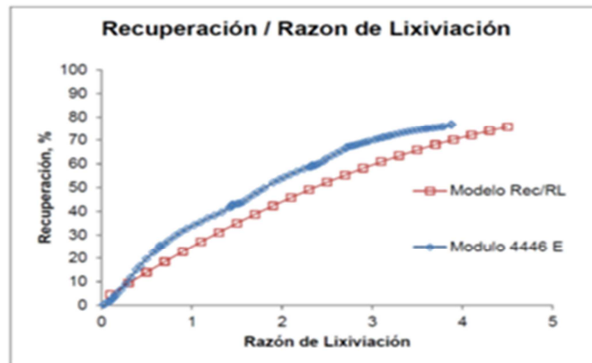
Figura 19: Extracción de cobre respecto a la razón de lixiviación, módulos industriales 4446E (alta ley).
