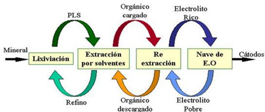
Figura 12: Descripción gráfica simple del proceso de recuperación de cobre vía hidrometalurgia.
