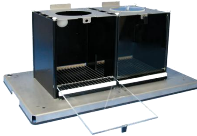
Figura 6. Fotografía del aparato utilizado para cuantificar el aprendizaje acústico. Cámara de condicionamiento, formada por cámaras que tienen comunicación, cada una capaz de producir el estímulo condicionante y por una rejilla sensible al movimiento que genera el estímulo no condicionante (corriente 0,5 mA)
