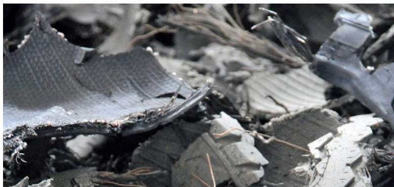
Figura 11. Material resultante después del proceso de pre-triturado. Fuente: VIVEROS Villa, Jorge. Estudio de prefactibilidad de una planta generadora de materia prima a base de neumáticos desechados.
