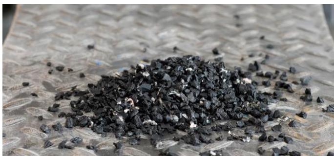
Figura 13. Material post proceso de molienda. Fuente: VIVEROS Villa, Jorge. Estudio de prefactibilidad de una planta generadora de materia prima a base de neumáticos desechados
