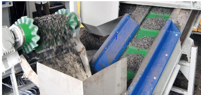
Figura 12. Material post proceso de granulación. Fuente: VIVEROS Villa, Jorge. Estudio de prefactibilidad de una planta generadora de materia prima a base de neumáticos desechados
