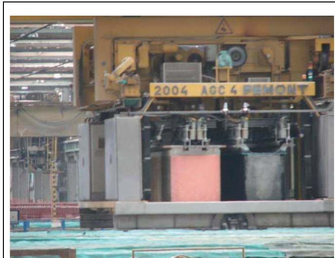
Figura 5: Automatic Guided Carriers (AGC), cargado con cátodos y scraps.
