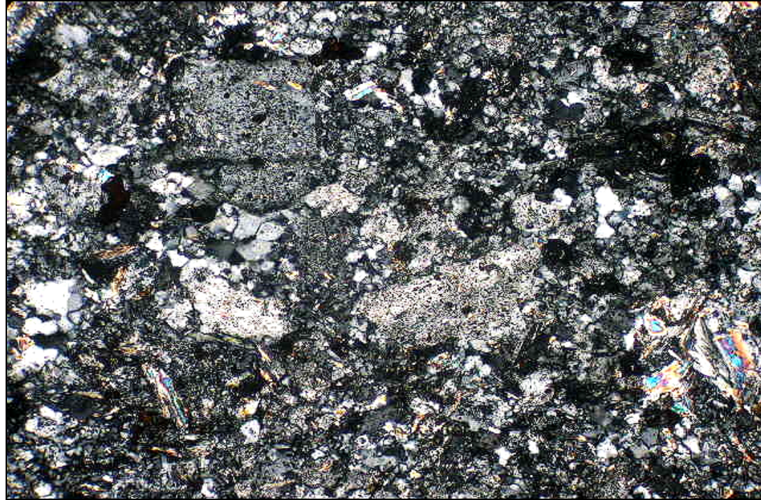
Muestra 160419: detalle de matriz en que se observan fenocristales de plagioclasa parcialmente fragmental en masa fundamental afanítica. Aum.: 10X10; Nic. cruzados.
