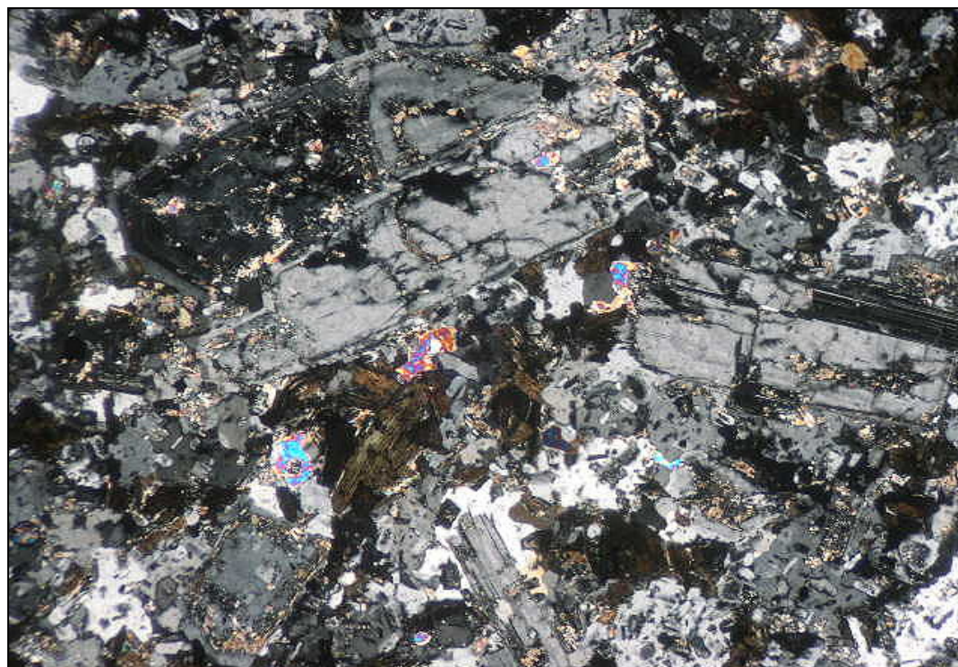
Muestra 160358: aspecto de la muestra en que se observan fenocristales de plagioclasa en masa fundamental microfanerítica. Aum.: 5X10; Nic. cruzados.
