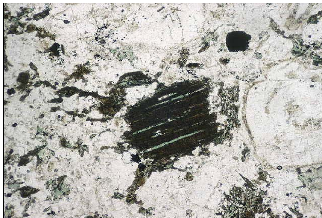
Muestra 160358: en la microfotografía se observan fenocristales de cuarzo con fuerte reabsorción magmática. Aum.: 5X10; Nic. cruzados.
