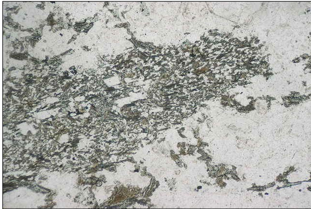
Muestra 160358: parte de pseudomorfo de hornblenda con reemplazo por biotita secundaria fina y clorita. Aum.: 5X10; Nic. paralelos.
