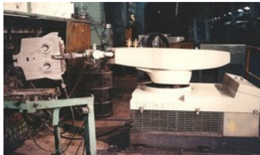
Ilustración 14: Unimate, primer robot manipulador de la empresa Unimation
