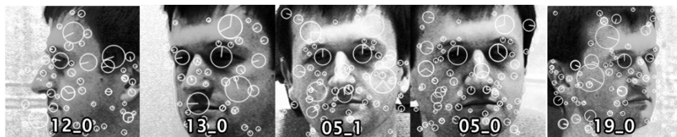
Figura III.4. Puntos de interés detectados con SIFT sobre imágenes de un mismo sujeto con variación de pose.
