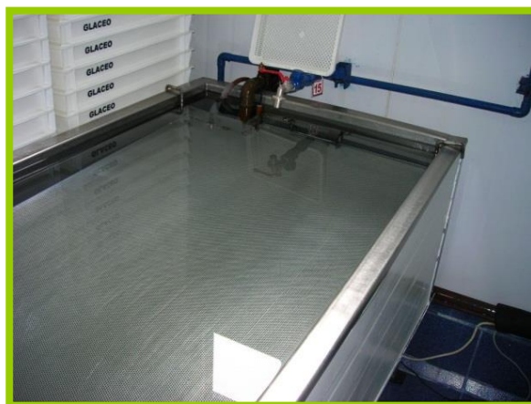
Figura 11. Tina de glaseado. Glazing tub . Fuente Informe de Diagnóstico Sectorial CPL.
