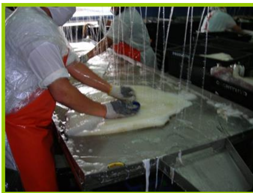
Figura 3. Lavado por duchas y corte de filetes. Fuente Informe de Diagnóstico Sectorial CPL. Washing by showers and cut of fillets.
