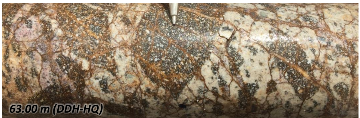
Fotografía 16. Brecha hidrotermal con matriz de sílice calcedónico y clastos de andesita porfídica a 63 m de profundidad en Sector Central-East Breccia (Sondaje CLATDH0019).
