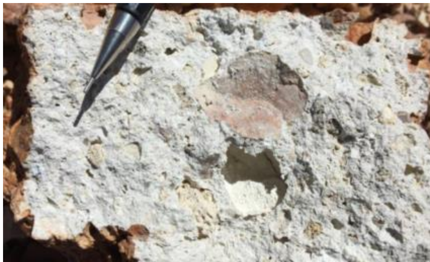
Fotografía 18. Brecha freatomagmática con alteración blanca – Caolinita-(Sondaje CLATDH0019).
