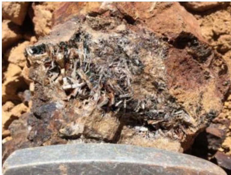
Fotografía 26. Afloramiento de estructura rellena con cristales de baritina blanquecina de aspecto lechoso con relleno de cavidades por Óx. Fe y Mn ( Sector Atlas Gold Zone ).
