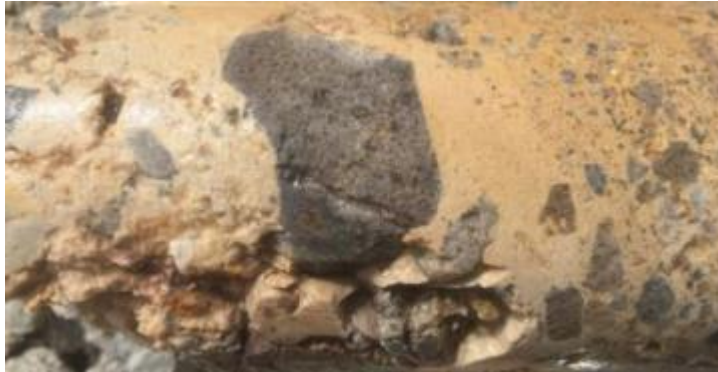
Fotografía 20. Zona de alteración Cuarzo-alunita, específicamente con relleno de matriz con cream silica (Sondaje CLATDH0015: 141.10 m).
