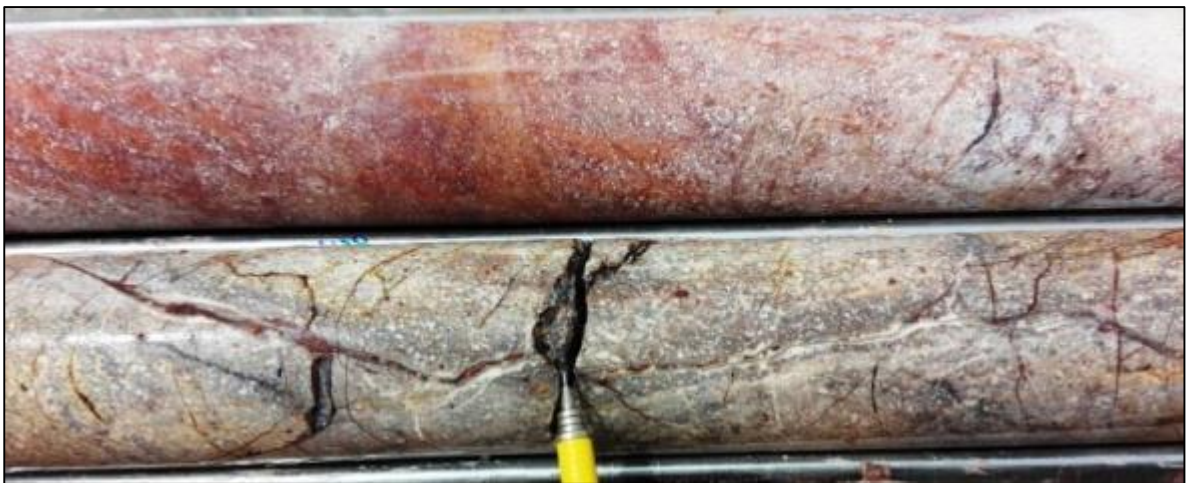
Fotografía 17. Andesita porfídica con alteración argílica, principalmente, selectiva en plagioclasas, y vetilleo variable de cuarzo calcedónico, Steam Heated Zone (Sondaje CLATDH0016, Prof: 110.10 m).
