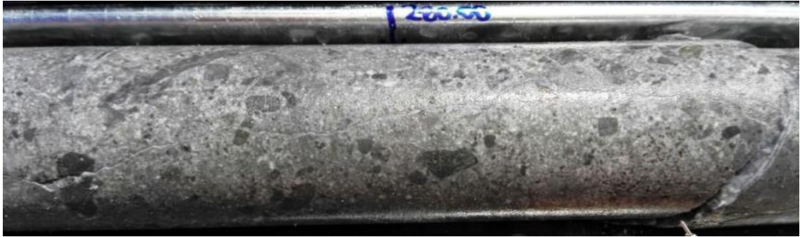
Fotografía 5. Sondaje CLATDH0017 (Profundidad 280 m) del Sector Atlas (Falda Zone), corresponde a una toba lito-cristalina de composición andesítica, correspondiente a la Subunidad Volcanoclástica-sedimentaria.
